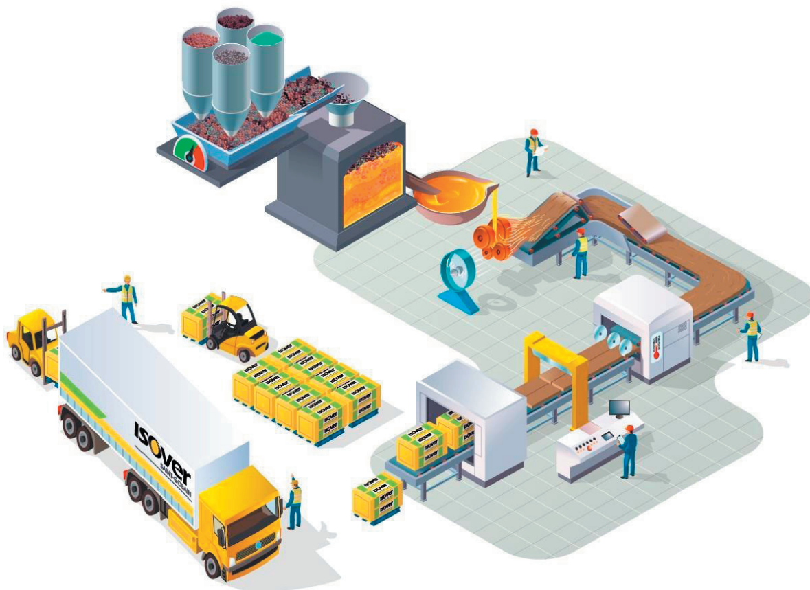
Obr. 3 – Schéma výroby minerální vlny
