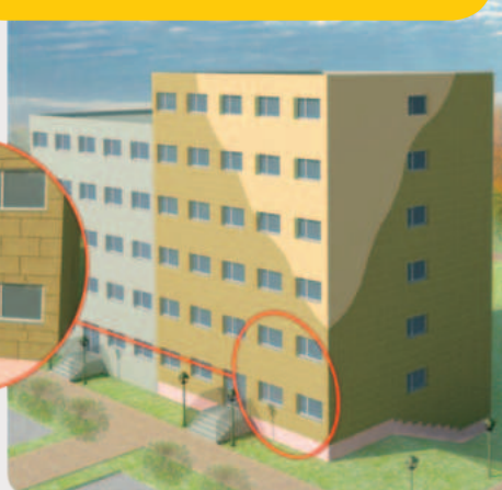
B) Zjednodušené řešení pomocí kombinované izolace Isover Twinner
