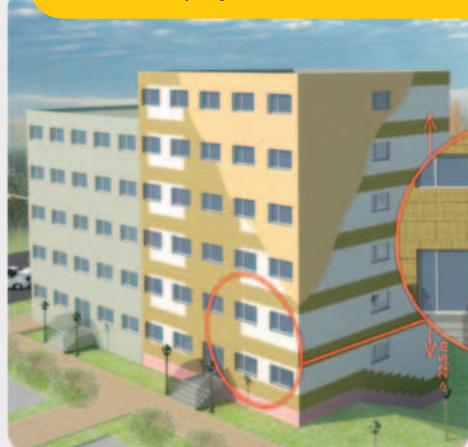
A) Standardní provedení střídáním tepelné izolace EPS s pásy minerální izolace šíře 900 mm
