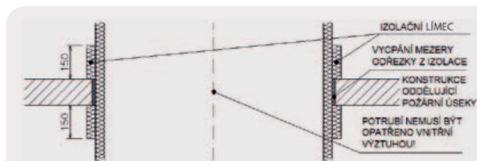
Obr. 29 Řez potrubím v místě prostupu požárně dělicí konstrukcí.
