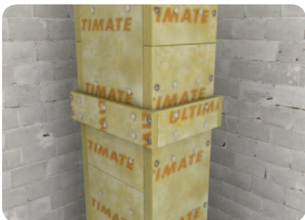
Obr. 47 Rozmístění trnů a vrtů Fire Screw u přidavné druhé vrstvy izolace.
