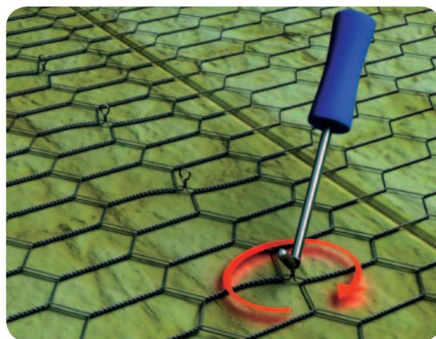
Obr. 58 Spojení rohoží překroucením přiléhajících okrajů pletiva do sebe po vzdálenosti cca 100 mm.
