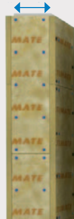
Obr. 73 Rozmístění trnů a vrutů u svislého potrubí.
