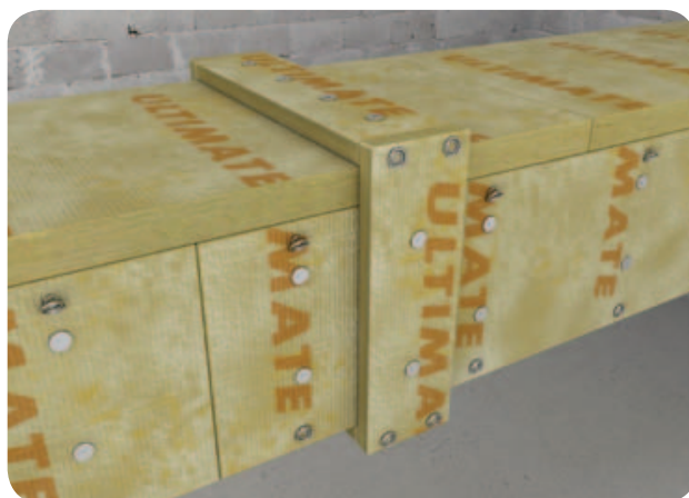
Obr. 46 Je-li použita deska o tloušťce izolace \leq 50 mm (nebo u závěsného profilu není dodrženo minimální krytí 30 mm), tak se nad přírubu (nebo nad profil) umístí pásek druhé vrstvy izolace o min. tloušťce 30 mm a šířce 150 mm.
