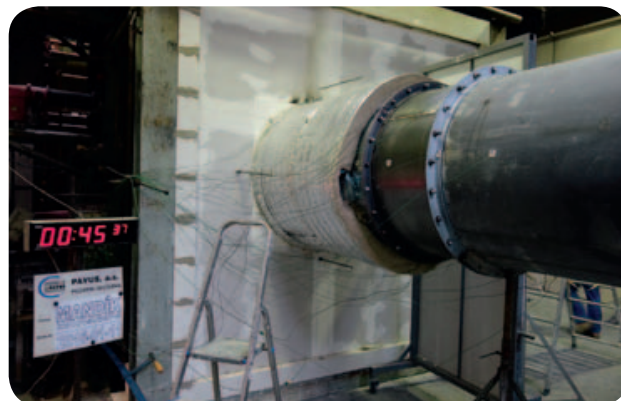
Obr. 82 Z materiálů Isover byl s předsazenými klapkami testován protipožární systém U Protect a to u výrobců MANDÍK, a.s. a Systemair a.s.
