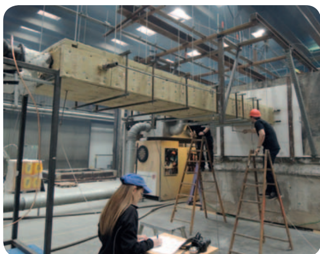
Obr. 16 Měření deformace potrubí typu C při zkoušce ve zkušebně.
