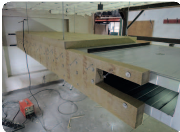
Obr. 71 Horní deska se nekotví přivařovacími trny, pouze se kotví požárními vrtů Fire Screw k boční desce.
