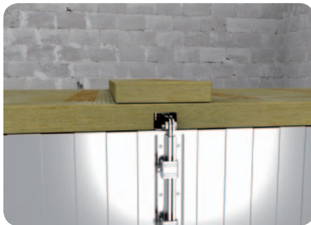
Obr. 46 Je-li použita deska o tloušťce izolace \leq 50 mm (nebo u závěsného profilu není dodrženo minimální krytí 30 mm), tak se nad přírubu (nebo nad profil) umístí pásek druhé vrstvy izolace o min. tloušťce 30 mm a šířce 150 mm.
