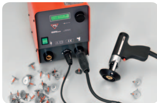
Obr. 24 Svařovací stroj pro přivařování hrotovým zážehem.
