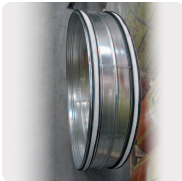
Obr. 55 Keramická páska 20 × 3 mm vložena mezi EPDM těsnění. V případě potrubí malých průměrů se používá užší keramická páska 9 × 3 mm, tak aby se vešla mezi gumové břity.
