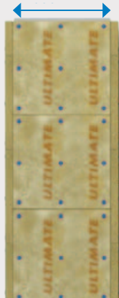
Obr. 73 Rozmístění trnů a vrutů u svislého potrubí.
