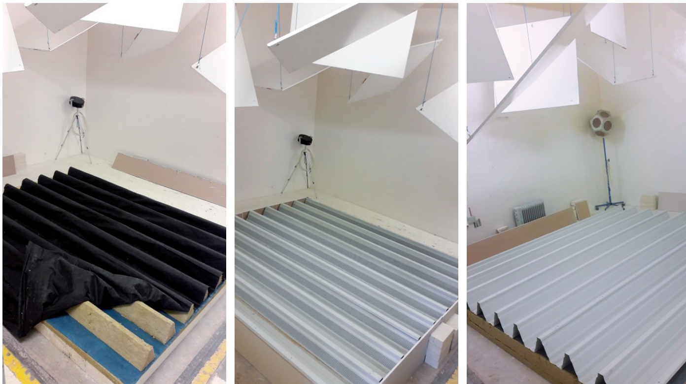
Obr. 7 Akustické střechy s perforovanými TR plechy ISOVER ROOF ACOUSTIC se zkouší na zvukovou pohltivost obráceně tj. TR plechem směrem nahoru do akustické měřicí komory. Tak se projeví silný pohltivý účinek perforovaného TR plechu s akustickou minerální výplní, nebo naopak odrazivý účinek standardního plnostěnného TR plechu bez perforace.
