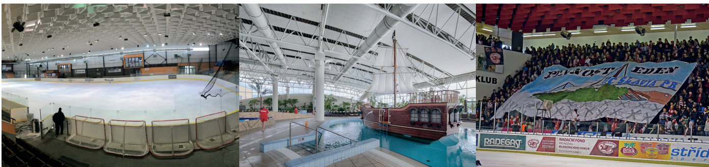
Obr. 1. Akustika halových staveb se dnes řeší všelijak, zejména zavěšováním textilních doplňků či materiálů na bázi textilu, na které sedá hořlavý prach.
