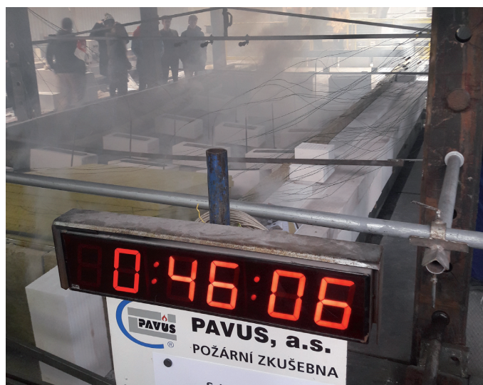
Obr. 11 Akustické ploché střechy ISOVER ROOF ACOUSTIC byly klasifikovány s požární odolností REI 45 DPI pro celovatovou izolaci MW. Foto požární zkoušky na začátku a ve 46 minutě. Střešní plášť je zcela funkční.
