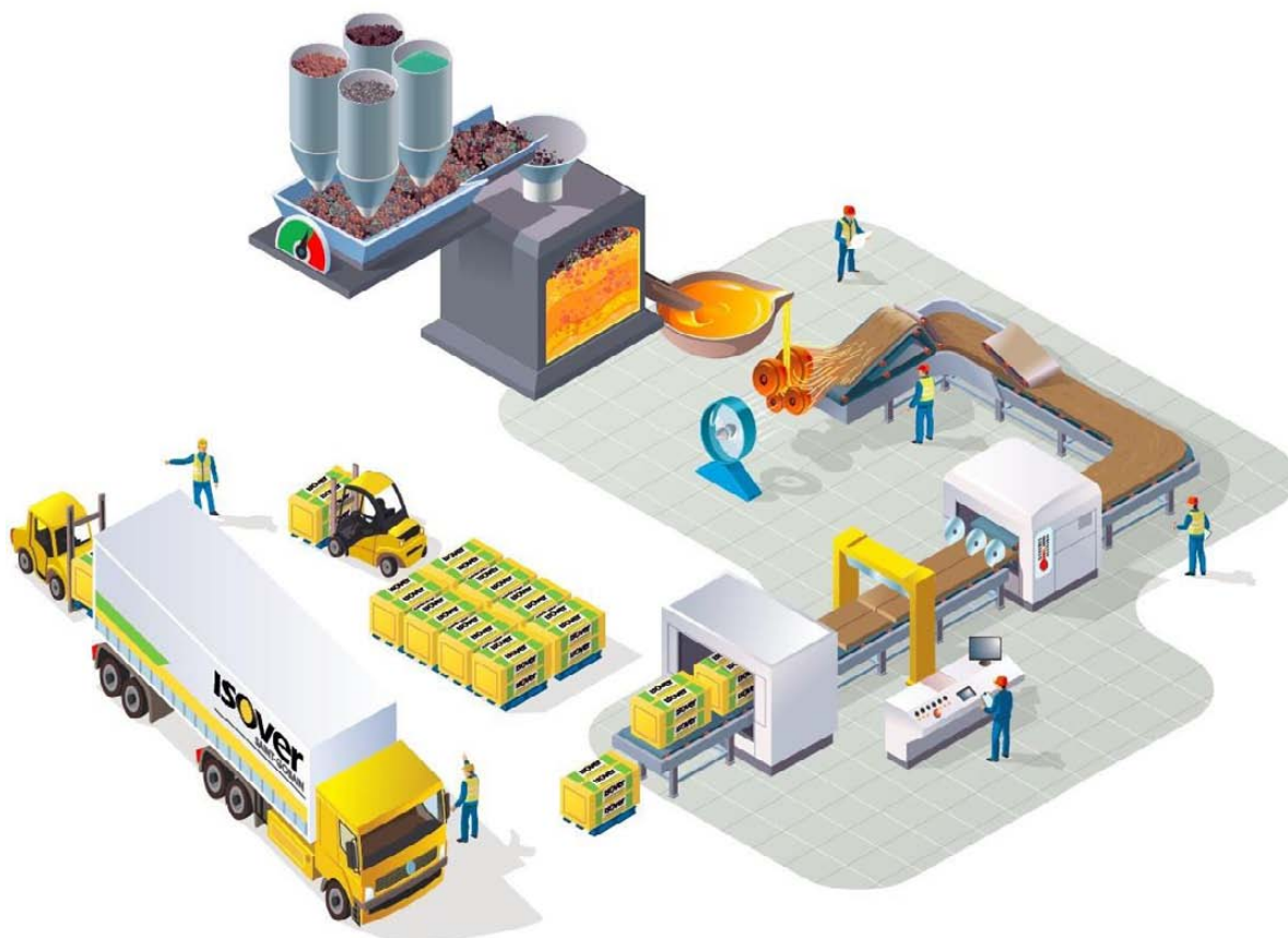
Obr. 3 – Schéma výroby minerální vlny
