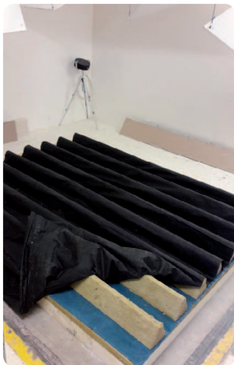
Obr. 7 Akustické střešky s perforovanými TR plechy ISOVER ROOF ACOUSTIC se zkouší na zvukovou pohltivost obráceně tj. TR plechem směrem nahoru do akustické měřicí komory. Tak se projeví silný pohltivý účinek perforovaného TR plechu s akustickou minerální výplní, nebo naopak odrazivý účinek standardního plnostěnného TR plechu bez perforace.
