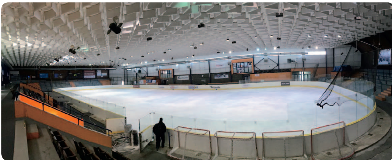
Obr. 1 Akustika halových staveb se dnes řeší všelijak, zejména zavěšováním textilních doplňků či materiálů na bázi textilu, na které sedá hořlavý prach.
