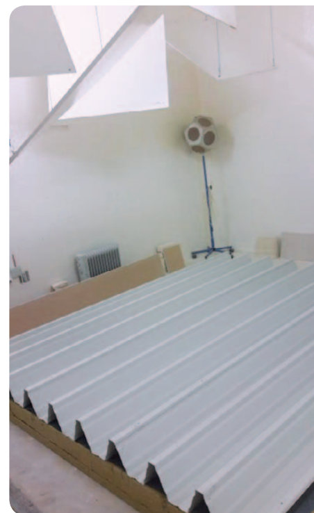
Obr. 7 Akustické střešky s perforovanými TR plechy ISOVER ROOF ACOUSTIC se zkouší na zvukovou pohltivost obráceně tj. TR plechem směrem nahoru do akustické měřicí komory. Tak se projeví silný pohltivý účinek perforovaného TR plechu s akustickou minerální výplní, nebo naopak odrazivý účinek standardního plnostěnného TR plechu bez perforace.
