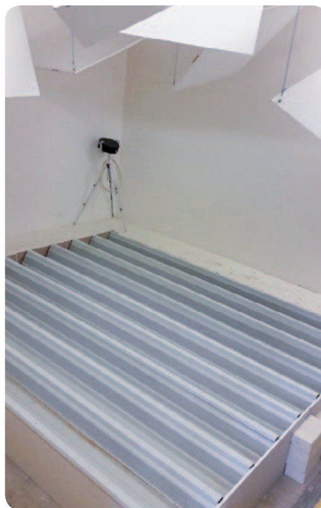
Obr. 7 Akustické střešky s perforovanými TR plechy ISOVER ROOF ACOUSTIC se zkouší na zvukovou pohltivost obráceně tj. TR plechem směrem nahoru do akustické měřicí komory. Tak se projeví silný pohltivý účinek perforovaného TR plechu s akustickou minerální výplní, nebo naopak odrazivý účinek standardního plnostěnného TR plechu bez perforace.
