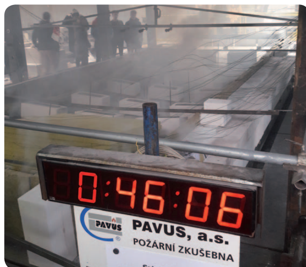
Obr. 10 Akustické ploché střešy ISOVER ROOF ACOUSTIC byly klasifikovány s požární odolností REI 45 DP1 pro celovatovou izolaci MW. Foto požární zkoušky na začátku a ve 46 minutě. Střešní plášť je zcela funkční.
