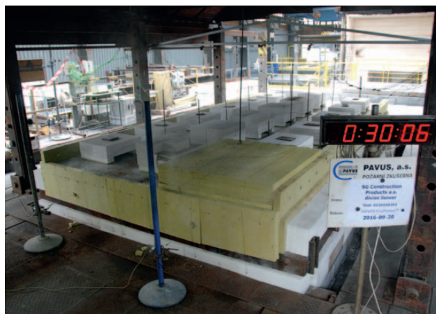
Obr. 10 Pohled na zkušební vzorek ve 30. minutě testu – protipožární obklad ISOVER FireProtect® plní 100% svou funkci, střecha je zcela bez deformace (střecha namáhána ohybově, stejně jako v provozním stavu za normální teploty) Návrh trapézové střechy
