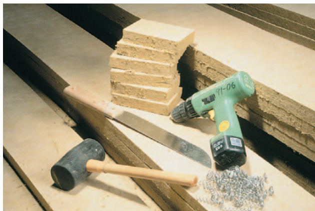
Obr. 1 Nástroje potřebné k instalaci protipožárních obkladů ISOVER FireProtect®
