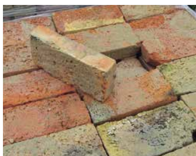
Plné cihly 450 mm > nahrazuje 20 mm tepelné izolace
