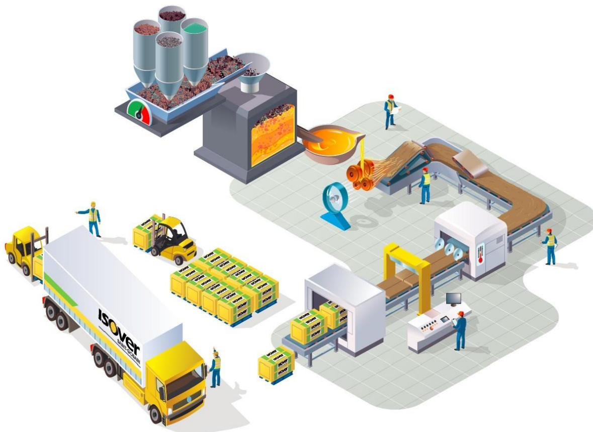
Obr. 3 – Schéma výroby minerální vlny
