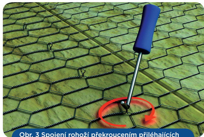
Obr. 3 Spojení rohoží překroucením přiléhajících okrajů pletiva do sebe po vzdálenosti cca 100 mm
