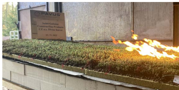
Požární zkouška ploché střechy
