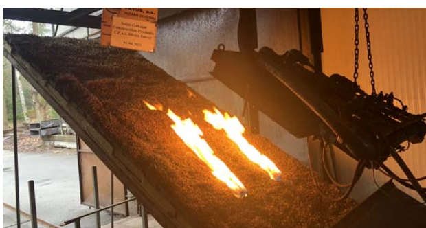
Průběh požární zkoušky šikmé střechy
