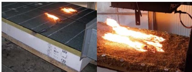
Příklady zkoušek skladeb vhodných pro požárně nebezpečné prostory s klasifikací B_{\text{ROOF}} (t3).
