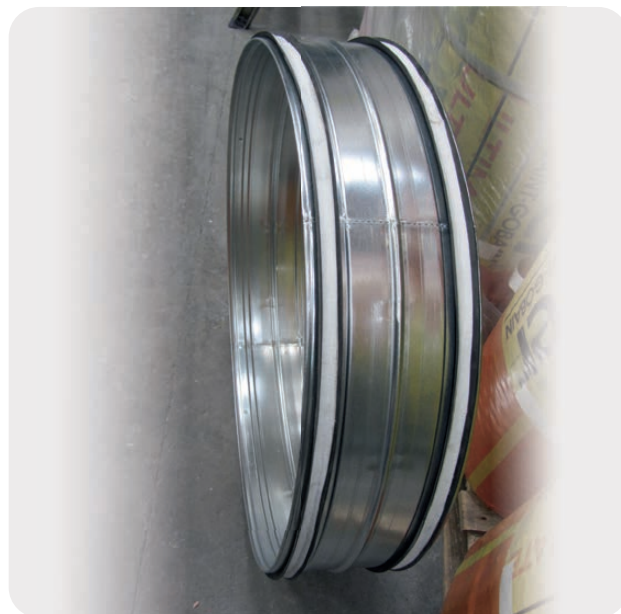
Obr. 52 Keramická páska 20 × 3 mm vložena mezi EPDM těsnění. V případě potrubí malých průměrů se používá užší keramická páska 9 × 3 mm, tak aby se vešla mezi gumové břity.
