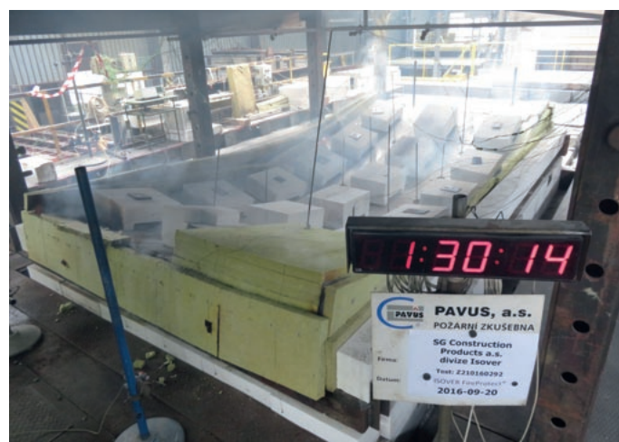
Obr. 4 Požární zkouška nejvýkonnější lehké požárně odolné střechy na trapézovém plechu na českém trhu s deskami ISOVER FireProtect® s požární odolností REI 90.
