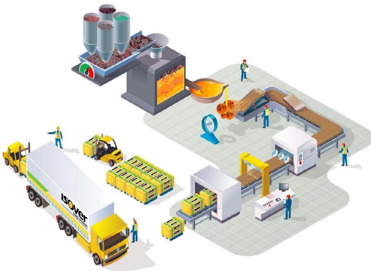
Obr. 3 – Schéma výroby minerální vlny
