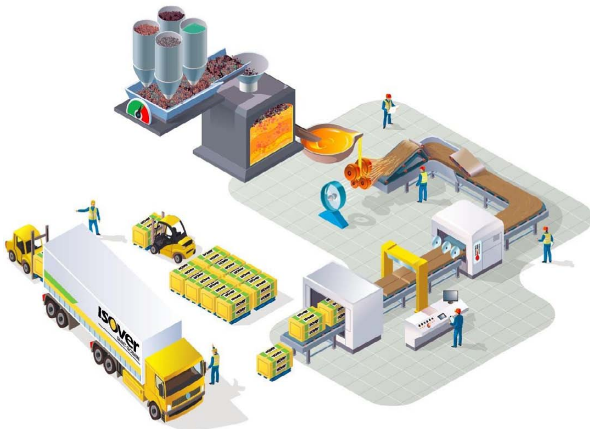
Obr. 3 – Schéma výroby minerální vlny
