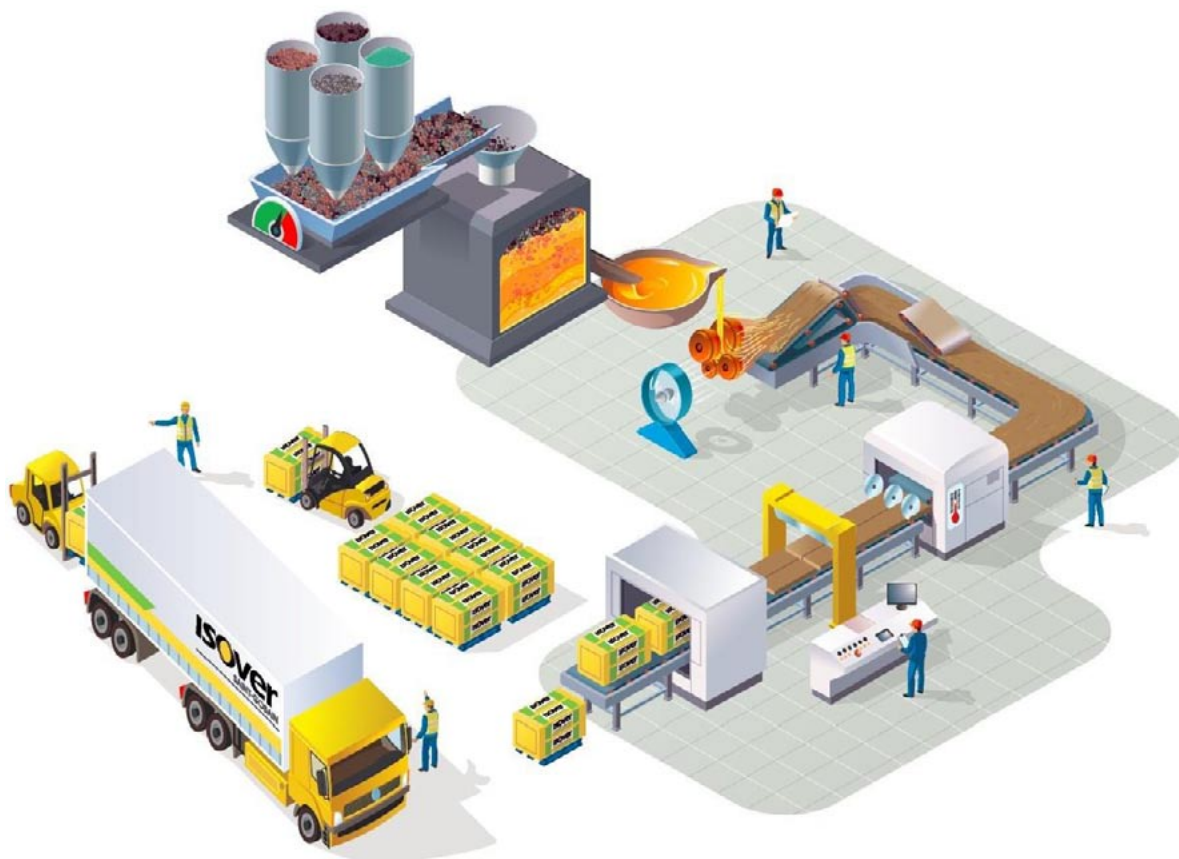
Obr. 3 – Schéma výroby minerální vlny
