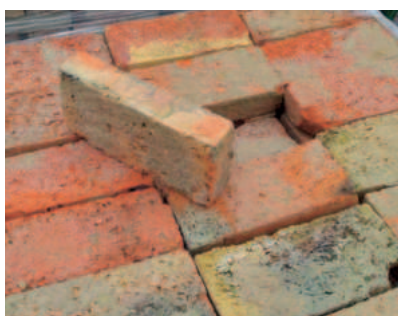
Plné cihly 450 mm > nahrazuje 20 mm tepelné izolace
