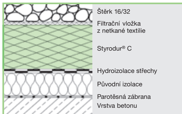
Obr. 3: Duo střecha s materiálem Styrodur® C.
