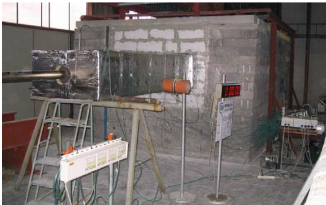
Obr. 28 Dvě ze série provedených zkoušek na čtyřhranném a kruhovém potrubí v certifikované požární zkušebně
