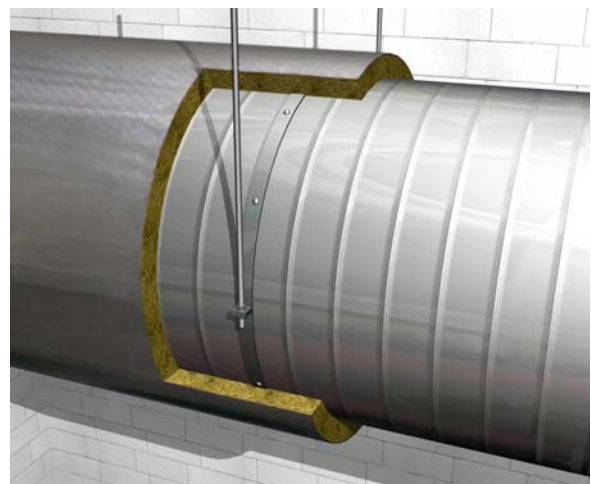
Obr. 21 Kruhové potrubí zavěšeno dvoudílnou objímkou
