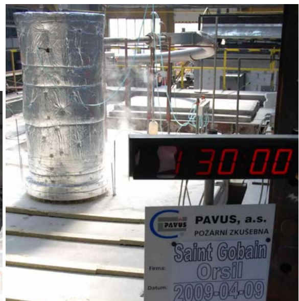
Obr. 28 Dvě ze série provedených zkoušek na čtyřhranném a kruhovém potrubí v certifikované požární zkušebně
